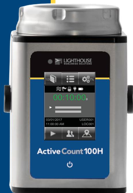
**A**ctiveCount100H是一个高性能便携式的空气采样器，它适合用在洁净室和无菌环境中。ActiveCount100H 是真正符合ISO 14698，它的d50采样效率是1微米，并带有用来防止采样空气重新吸入设计的高效过滤排气口。
